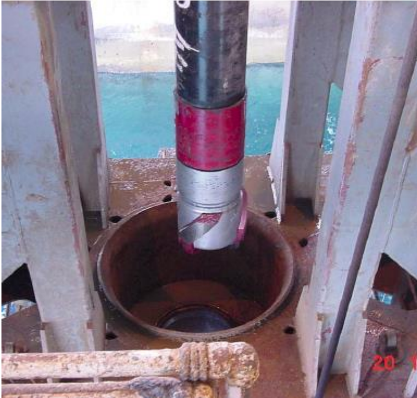
Рис. 4 Схема низа компоновки при бурении обсадными трубами.
