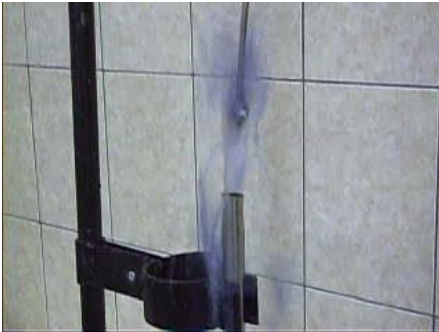
Рис.8 Выброс инструмента и БР в лабораторных условиях
